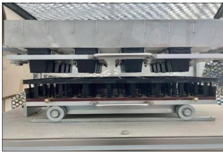
그림 2. 화분분배기 기존 제품(좌)과 개선품(우)의 트레이 이동 및 여유공간 비교
