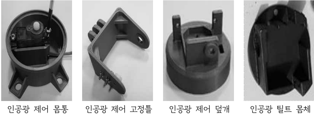
그림 2. 3D 프린터기를 활용한 조류퇴치기 조형물 제작
