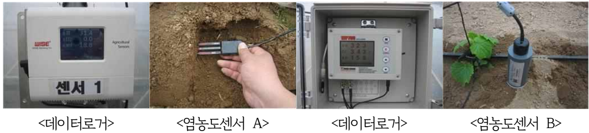
그림 6. 토양염농도 센서 시험하우스 설치
