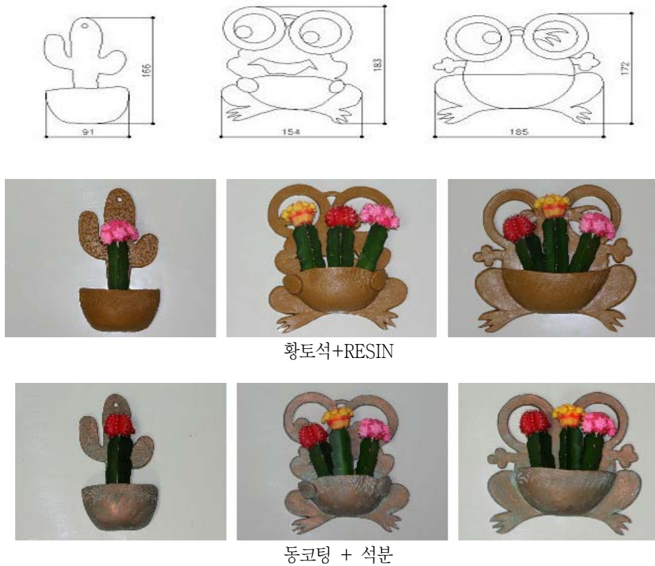
그림 3. 벽 부착용 용기 설계도 및 샘플 시제품
